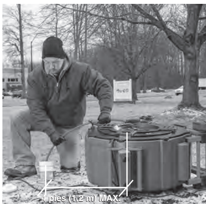
Figura 10 – El operario en posición correcta para trabajar
