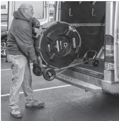
Figura 17 – Colocación de la máquina en el camión
