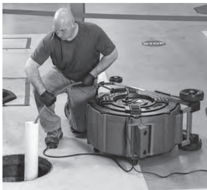
Figure 5 – Exemple de prolongation de conduite à moins d'un mètre de la sortie de câble de l'appareil.
